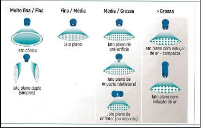
Figura 9: Descrição das principais famílias de pontas de pulverização, adaptado de Agrorefetiva.
